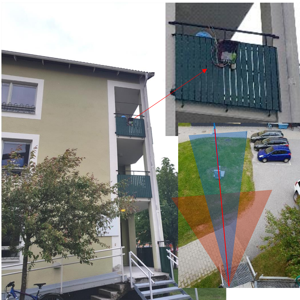
Figur 6. Testupställning på campus Åkroken. Placering av nod och dess övervakningsområden. Rött område i bilden längst ner till höger, indikerar övervakningsområdet för kamera 1 och blått område för kamera 2. Röd linje representerar den virtuella linje där personer registreras att lämna eller gå in i området.
