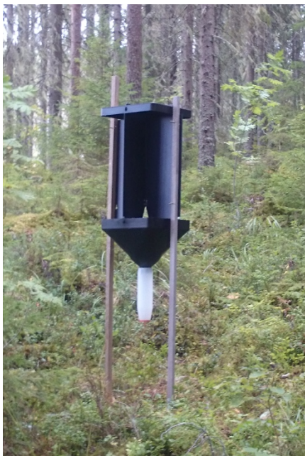
En övervakningsfälla för dubbelögade bastborrar. Samma typ av fälla användes också vid utvecklingen av feromonbeten för bastborrarna.
