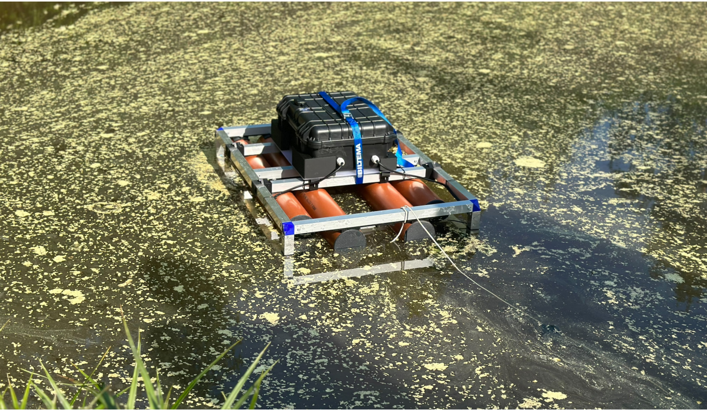
Bild ovan. Inom DIGIT och Forskningsarenan har Mittuniversitetet utvecklat en autonom båt som mäter sedimentnivåer i vatten.
